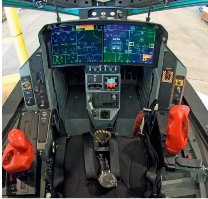
洛·马 F-35 的座舱，大块触摸屏是人机新交互方式的技术前提之一
